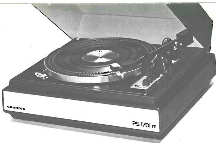
La potenza di uscita di un amplificatore può essere condizionata dal livello del segnale d'ingresso. Accoppiando una piastra di riproduzione ad un amplificatore bisogna prestare attenzione a che non si manifestino fenomeni di scarso pilotaggio o di saturazione. Nell'immagine la piastra automatica PS 1701 m della Grundig.
