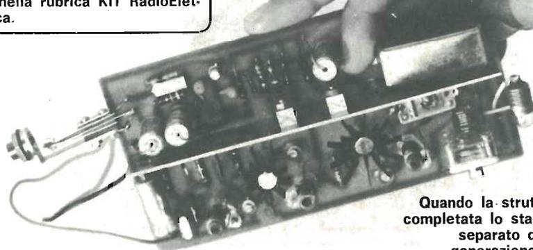
Quando la struttura del trasmettitore è stata completata lo stadio di bassa frequenza risulta separato dalla sezione in cui avviene la generazione della radiofrequenza. Questo accorgimento è stato adottato per evitare che si manifestino accoppiamenti parassiti.
